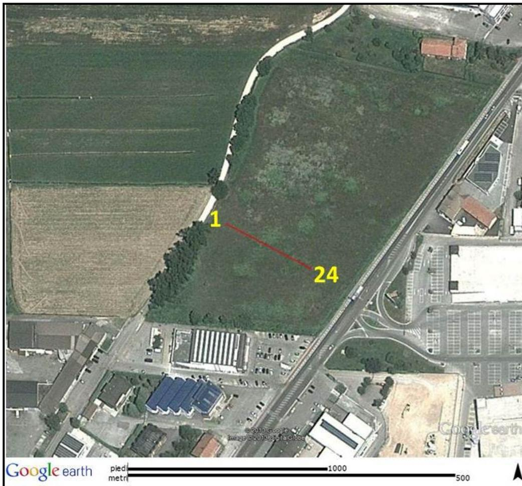
Fig. 6 Borgo San Dalmazzo 2 – Dettaglio dello stendimento e localizzazione della posizione dei geofoni. Le sorgenti sono state posizionate dal lato del geofono 1.
