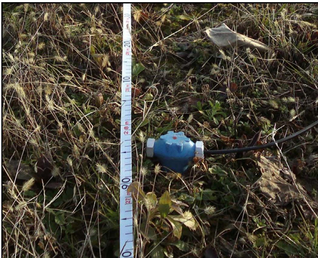
Fig. 4 Geofono verticale con frequenza di risonanza a 4.5Hz
