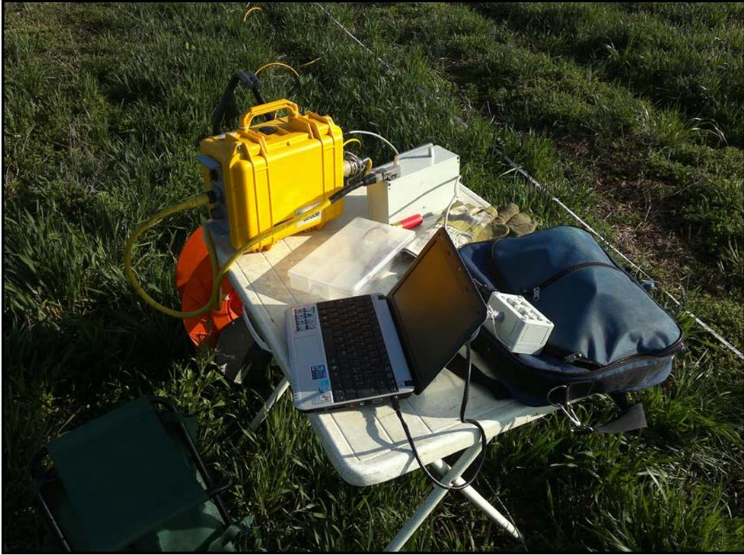
Fig. 2 Sismografo a 24 canali della Geometrics (in giallo) collegato ad una batteria al Pb a 12V e in primo piano il PC per il salvataggio delle acquisizioni e la gestione dei parametri di indagine.
