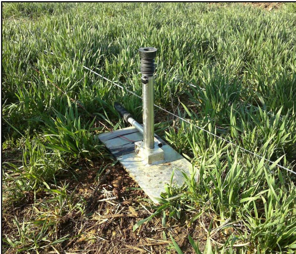
Fig. 3 Fucile sismico utilizzato per le energizzazioni. Modello ISOTTA prodotto e distribuito da PASI.
