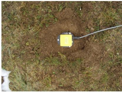
Fig. 1- Orientamento sensore Veloget e accoppiamento strumento-terreno
