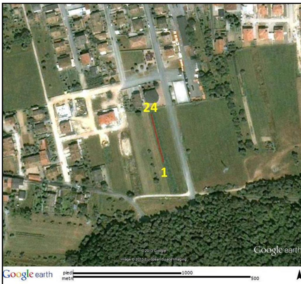
Fig. 5 Borgo San Dalmazzo 1 – Dettaglio dello stendimento con la posizione del primo geofono e del ventiquattresimo. Le sorgenti sono state posizionate dal lato del primo geofono.
